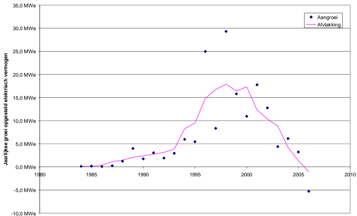
Figuur 2: Bijgebouwd elektrisch vermogen WKK-motoren in Vlaanderen tussen 1983 en 2006.
