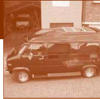
PV-modules op een kampeerwagen (Lenoir Solar)
